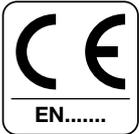
CE-Kennzeichnung für Produkte, die gemäß einer harmonisierten europäischen Norm (EN) geprüft und zertifiziert sind
